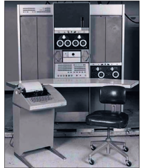
► Первый в мире UNIX-хост DEC PDP-7. Обратите внимание – на переднем плане слева первый в мире /dev/tty0.
